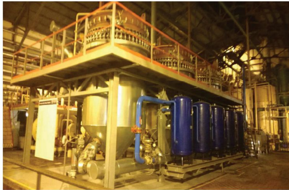
Stacja filtracji-(cukrownia Zerdievka 2015,wspólny projekt PCM i Gaudfrin, )
